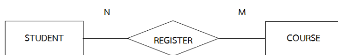
ภาพที่ 2.18 แสดงความสัมพันธ์แบบ Many to Many Relationships
